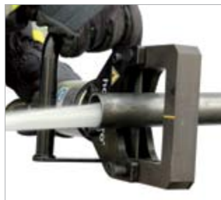
Отличная комбинация: разлом бетона при помощи СС 20 С и перерезание арматуры мини резаком CU 4007 С (или SMC 4006 С).
