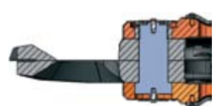
Непосредственно стягивает лезвия, обеспечивает лучшие режущие возможности
